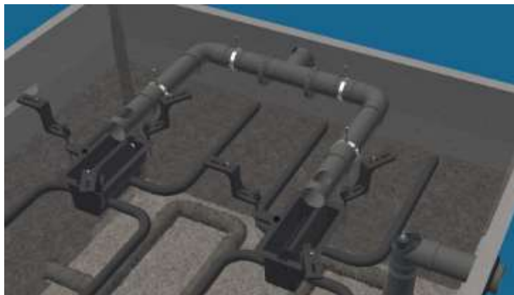
Fig-7 : Exemple de dispositif de répartition dans un filtre C-90 6,5m 3
