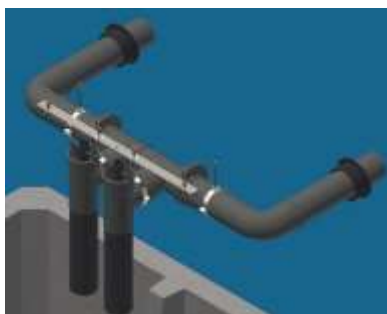
Fig-8 : Dispositif de répartition et préfiltre dans un décanteur primaire
